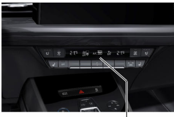
Unité de commande et d'affichage du climatiseur, à l'avant E87
