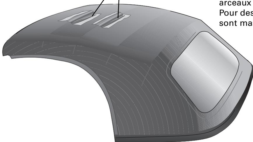
Le sens de tissage et la tension de la toile de la capote ont été définis de sorte à obtenir une application aussi longue que possible du flux d'air.
