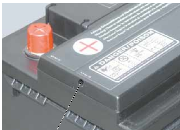
Orifices de dégazage central
