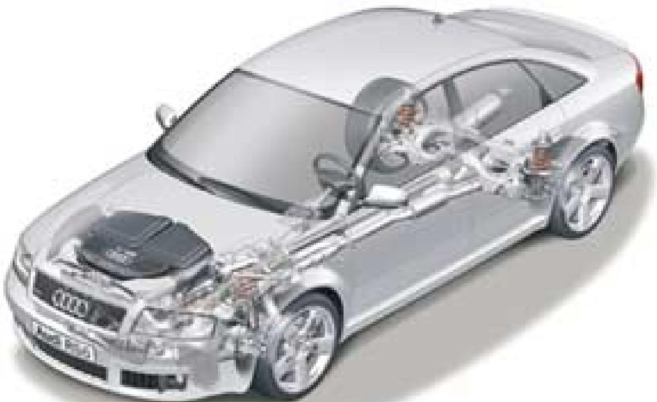
Le système spécial d'amortissement Dynamic Ride Control (DRC) est utilisé pour la première fois sur l'Audi RS 6.
