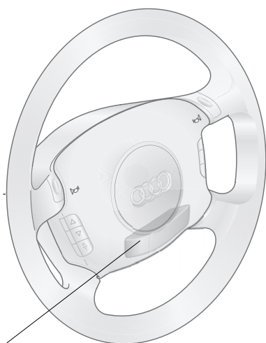
Appareil de commande de volant de direction multifonction J453 avec unité de commande E221
