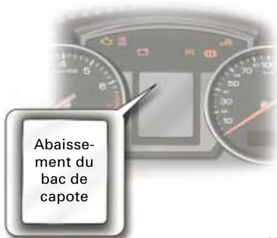
**!** En cas de tentative d'ouverture de la capote sans avoir abaissé le logement de capote variable, il y a édition d'un message d'information sur l'afficheur du combiné d'instruments.
