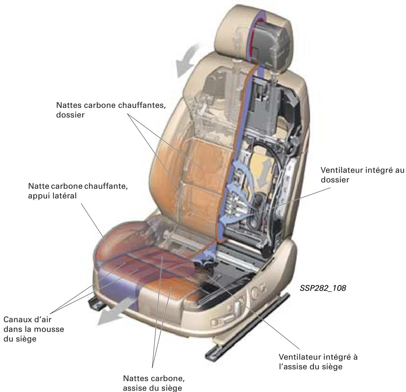
La climatisation des sièges est assurée par des ventilateurs intégrés dans l'assise et le dossier de siège. De l'air tempéré par le chauffage du siège est acheminé jusqu'au passager via des canaux d'air pratiqués dans la mousse du siège et sort par une fine perforation du cuir.
