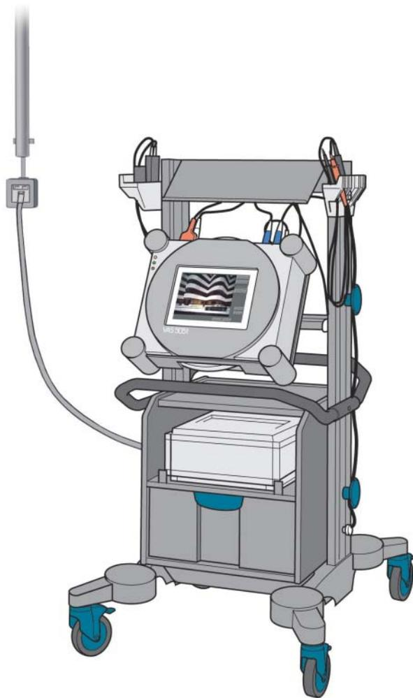
Le système de diagnostic VAS 5051 n'autorisait jusqu'à présent que la communication avec le véhicule. La connexion en ligne élargit le spectre de performances du contrôleur.
