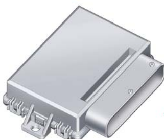
Calculateur de freins de parking et à main électriques J540 à gauche dans le coffre à bagages
