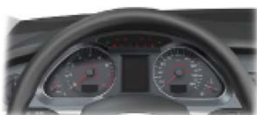
Calculateur avec unité de commande dans le porte-instruments J285
