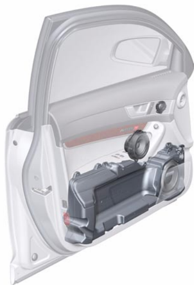
Porte avant de l'Audi A6 05 avec caisson de basses et logement des haut-parleurs
