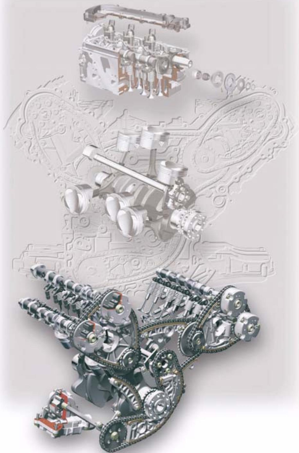
Le positionnement de la commande par chaîne côté boîte et la répartition sur deux niveaux d'une distribution par chaîne à quatre étages autorise une construction compacte du moteur. Cela a permis de monter des moteurs à plusieurs cylindres dans les séries de modèles plus compactes sans devoir allonger l'avant du véhicule. La commande par chaîne contribue, lors des opérations du service, à la réduction des coûts d'exploitation car elle est exempte d'entretien et répond au concept Long Life.
