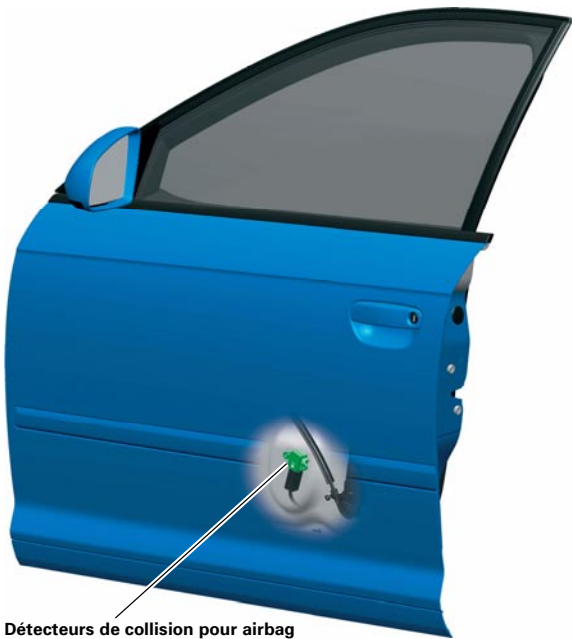
Détecteurs de collision pour airbag latéral dans la porte avant
