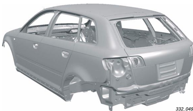
Caisse - vue arrière de la carrosserie
