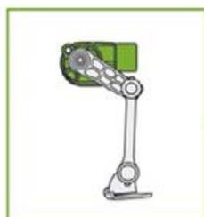
G475 Capteur de position droit du module de basculement (conception spécifique constructeur)
