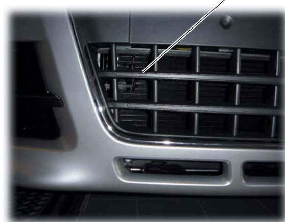
Détecteur de température extérieure (directement en amont du condenseur)
