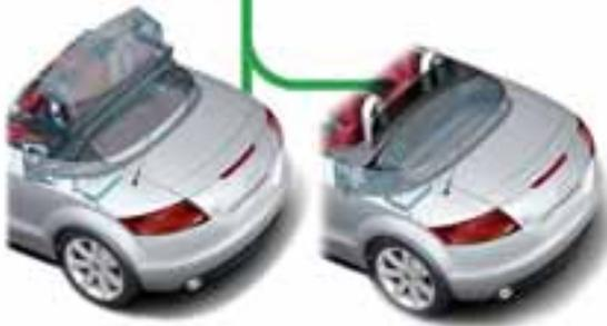
Ouverture/fermeture confort de la capote
