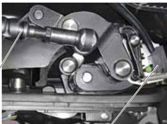
Contacteur de verrouillage de capote, fermé F295 partie supérieure droite de la serrure
