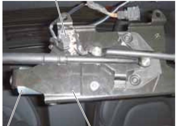
Moteur de verrouillage de la capote V223
