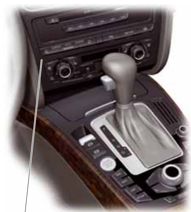
Unité de commande -module de commande Audi drive select pour système E592
