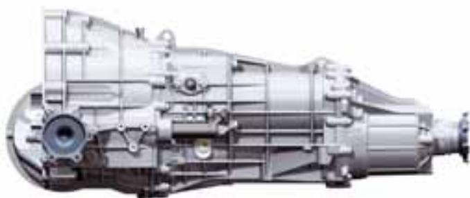
0B2 – pour transmission quattro et toutes les motorisations jusqu'à 350 Nm
