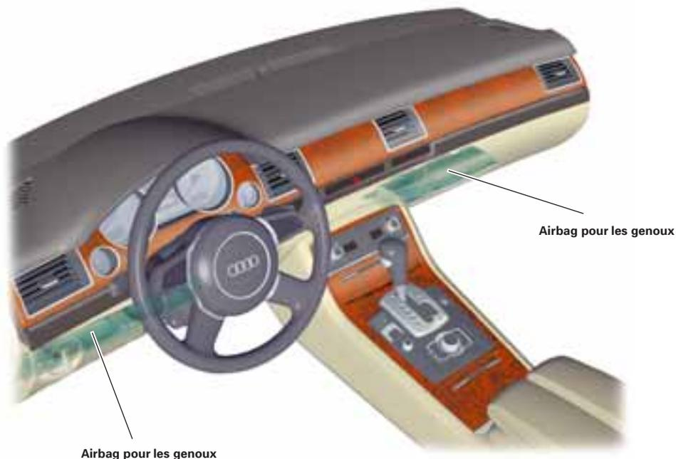
Le déclenchement des airbags pour les genoux permet aux occupants du véhicule de participer plus tôt à la décélération du véhicule. Le système d'airbag permet ainsi, avec les airbags frontaux côté conducteur et passager avant combinés aux airbags pour les genoux, de satisfaire aux exigences légales et spécifiques de certains pays.
