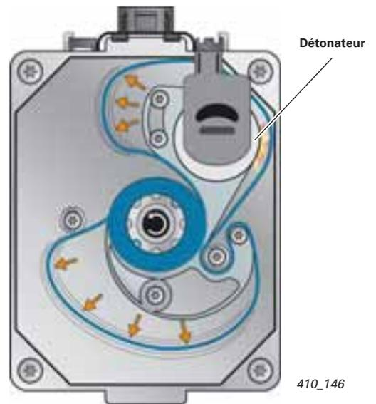
La surface du boîtier et celle du couvercle du boîtier entre lesquelles la bande métallique se déplace sont pourvues d'une couche de silicone. Lorsque la bande métallique se déplace, elle repousse devant elle une partie de cette couche de silicone, qui assure alors l'étanchéité. Cela permet de réduire les pertes de pression.
