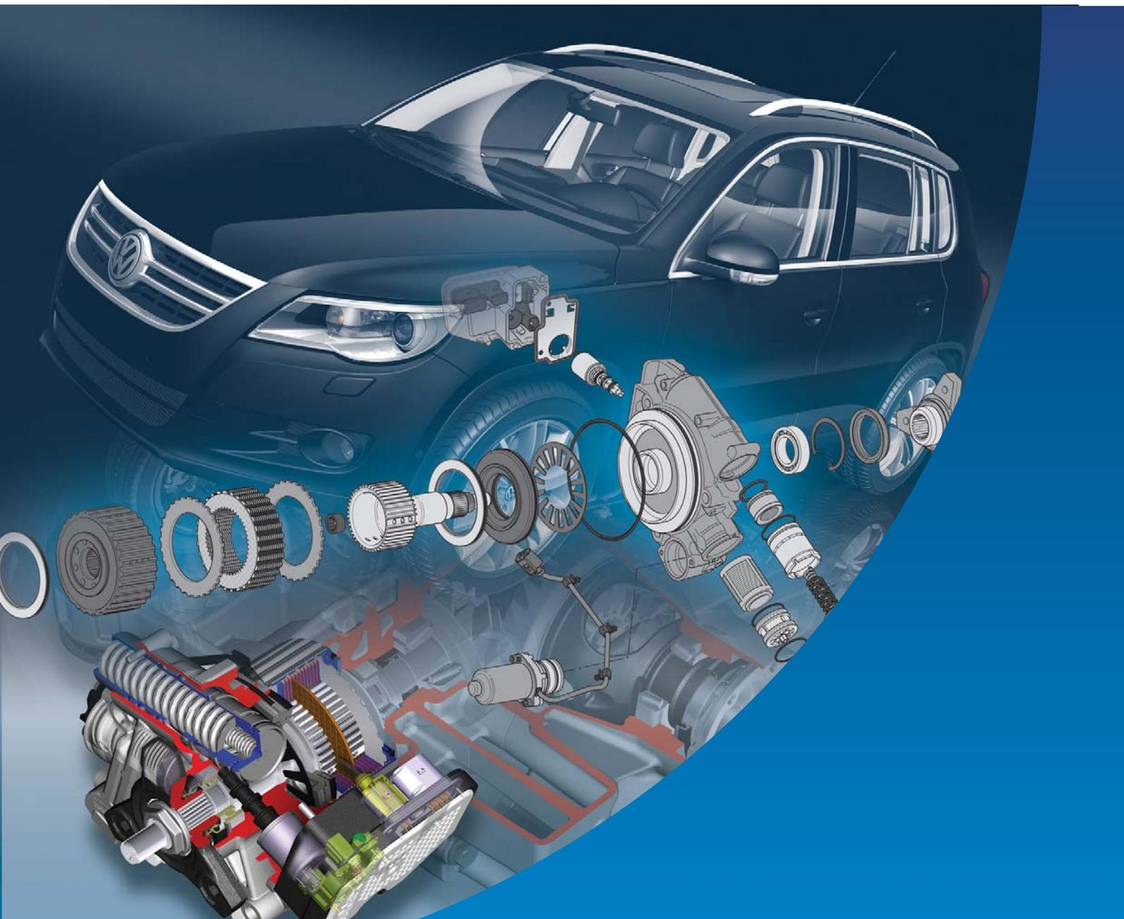
Depuis 1998, Volkswagen fait appel à un coupleur Haldex pour la réalisation de la transmission intégrale 4MOTION. Le Tiguan est le premier véhicule à être équipé de la nouvelle génération du coupleur 4x4.
