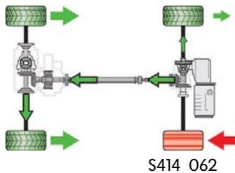
Si une seule roue de l'essieu avant patine, le blocage électronique de différentiel (EDS) intervient en freinant la roue qui patine et augmentant ainsi la force d'entraînement de l'autre roue. Simultanément, le coupleur 4x4 est fermé et une grande partie de la force d'entraînement est transmise à l'essieu arrière.
