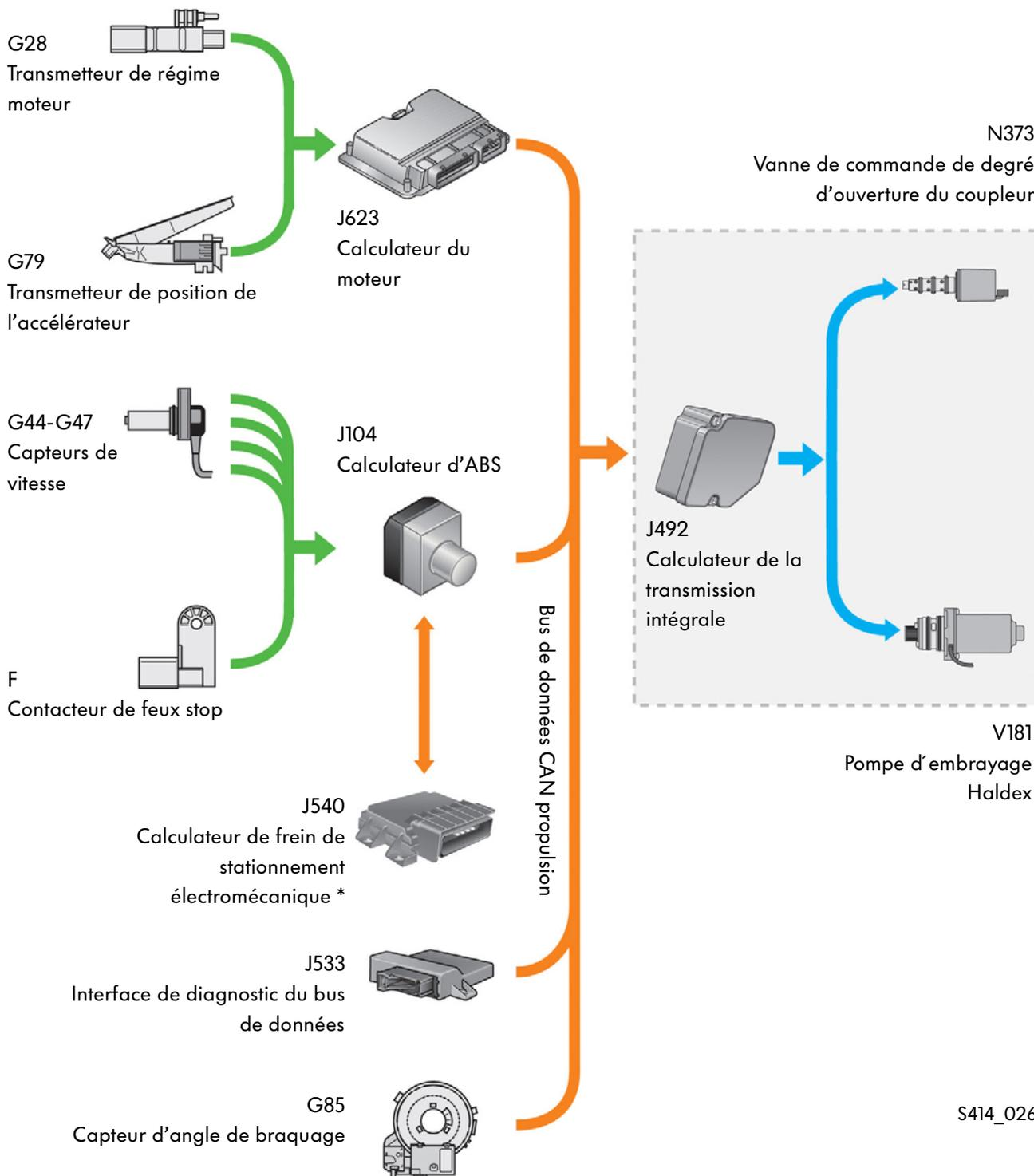
\* Un groupe de capteurs est intégré dans le calculateur de frein de stationnement électromécanique. Il comprend le capteur d'accélération transversale, le capteur d'accélération longitudinale et le capteur de vitesse de lacet.
