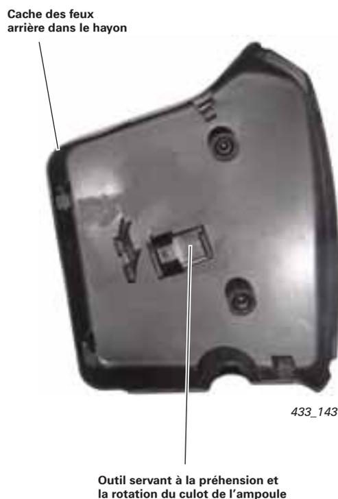
Il faut déposer les feux arrière supplémentaires pour le remplacement des ampoules. Le filetage est, comme sur l'Audi Q7, accessible après dépose des caches dans le pare-chocs.
