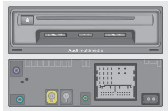
Calculateur J794 du système MMI Navigation plus sur Audi A6, A8 ou Q7
