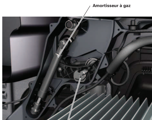
Moteur gauche de cuve de logement de capote
