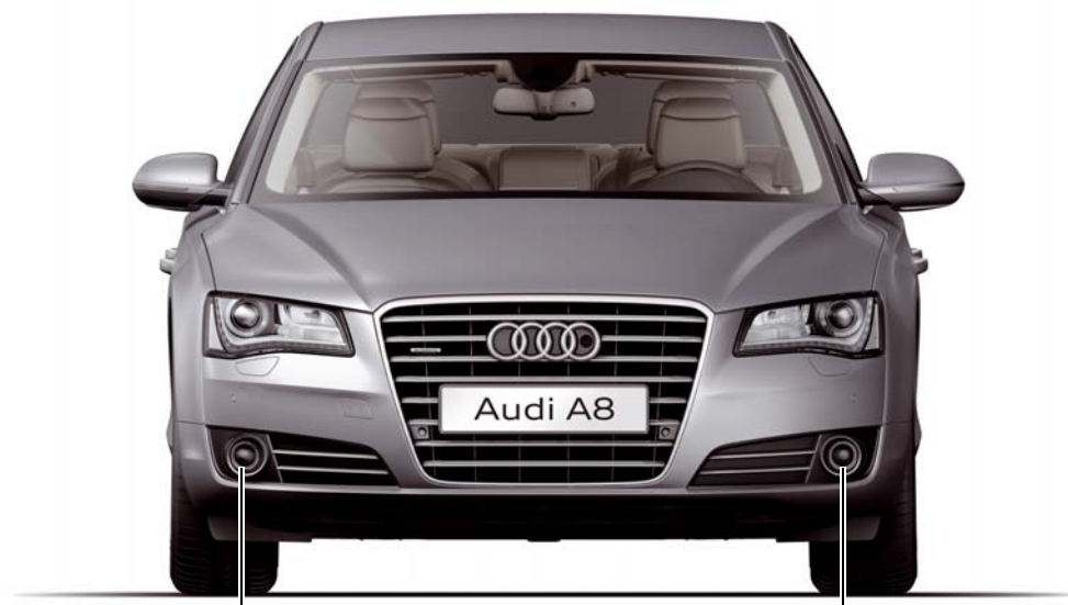
Transmetteur droit de régulateur de distance G259 et calculateur de régulateur de distance J428
