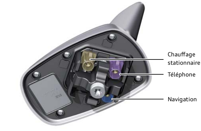
Antenne de pavillon R216 (Europe/reste du monde)
