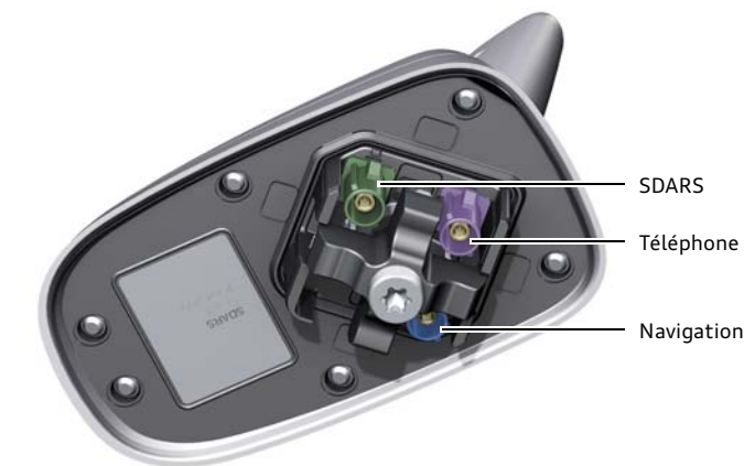
Antenne de pavillon R216 (Amérique du nord)
