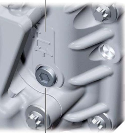
Vis de remplissage et de contrôle d'huile de pont
