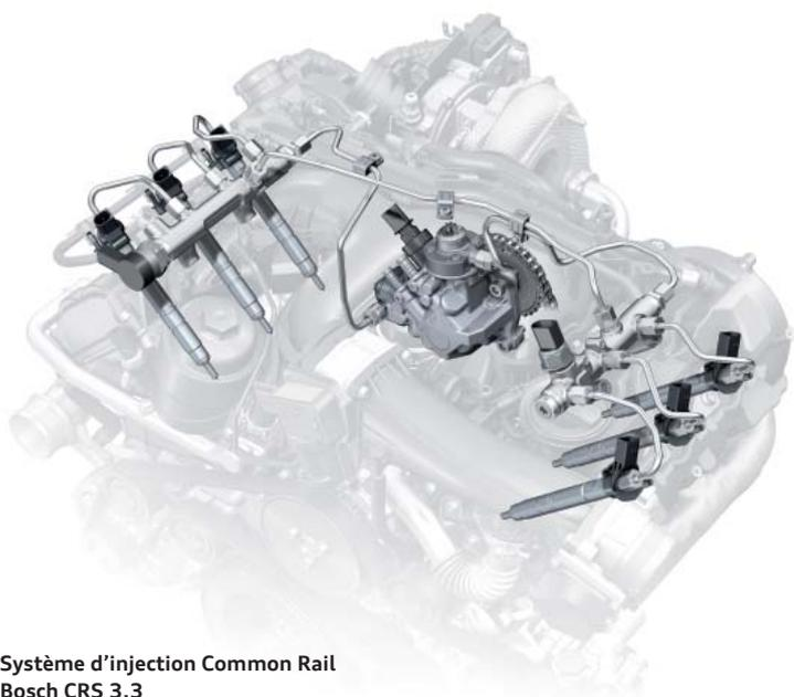
Système d'injection Common Rail Bosch CRS 3.3
