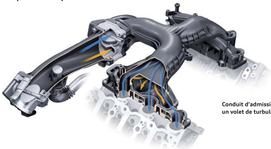
Conduit d'admission avec un volet de turbulence
