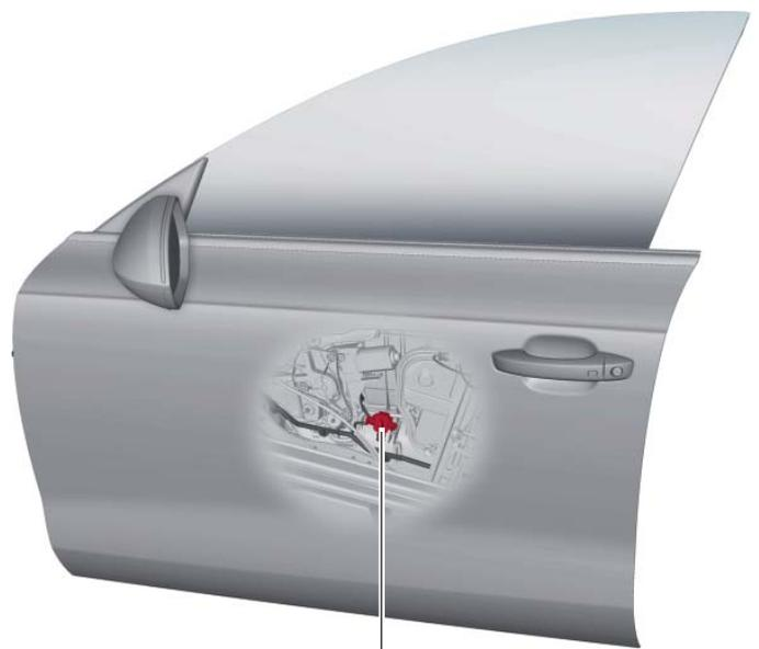
Capteur de collision G179
