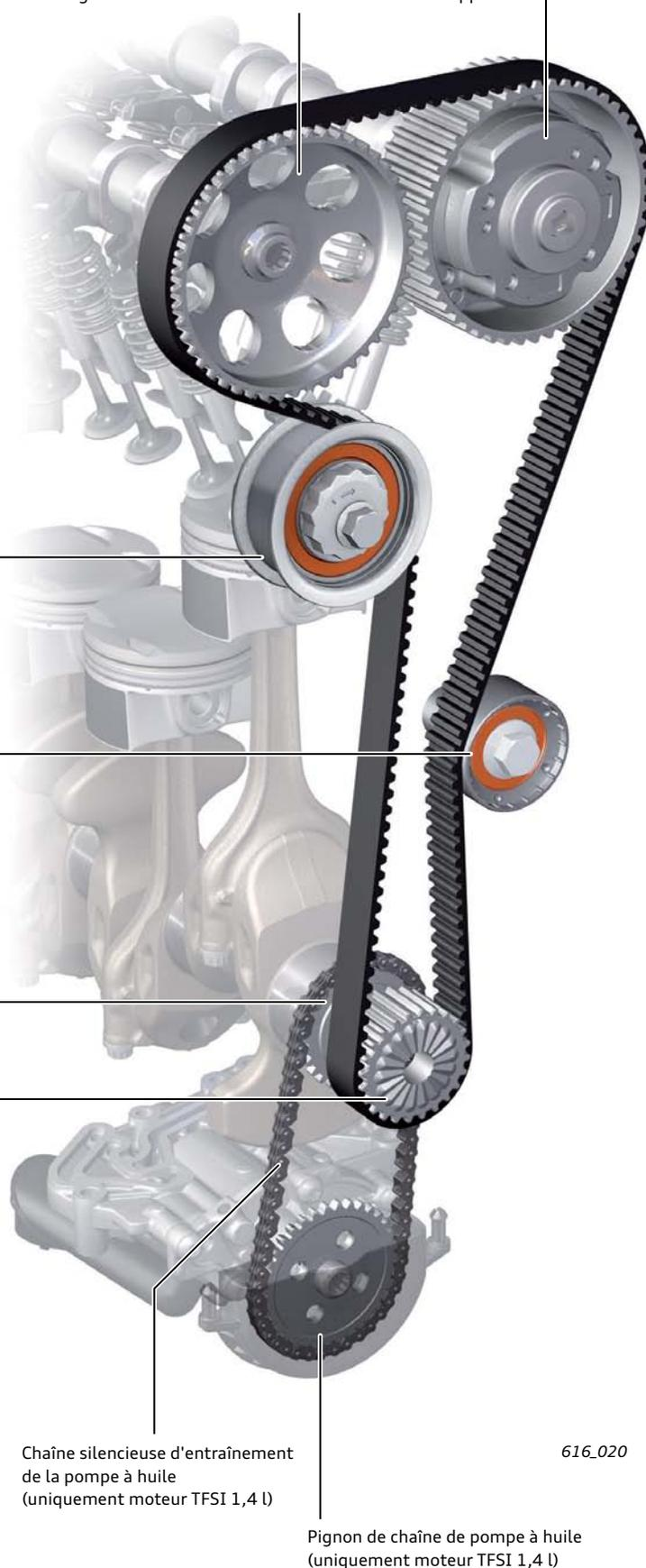
Chaîne silencieuse d'entraînement de la pompe à huile (uniquement moteur TFSI 1,4 l)
