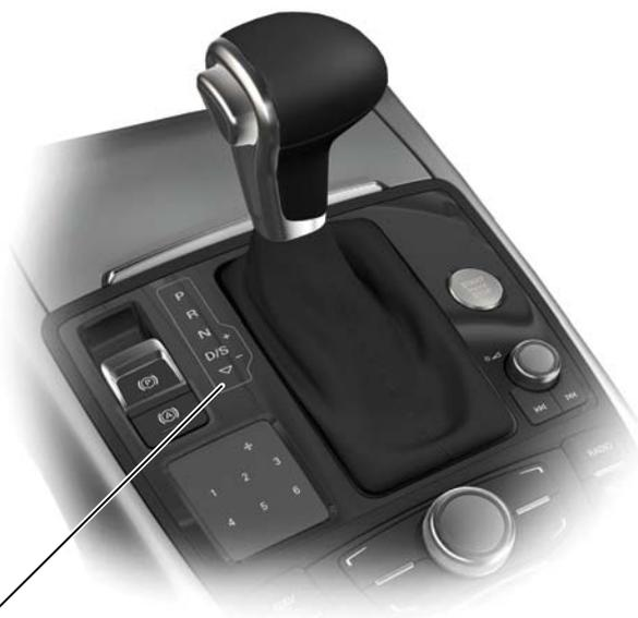
La grille des vitesses avec indication de passage des rapports est intégrée dans le cadre design de la console. L'unité d'affichage Y26 est montée par en dessous comme composant distinct.
