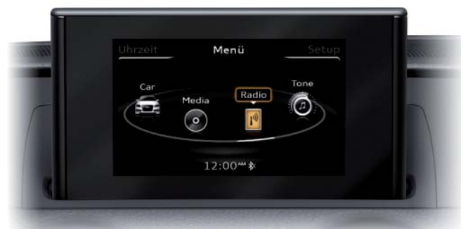
Écran MMI de la MIB Entry plus sur l'Audi A3 2013 618_013
