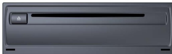
Façade du J794 sur la MIB Entry
