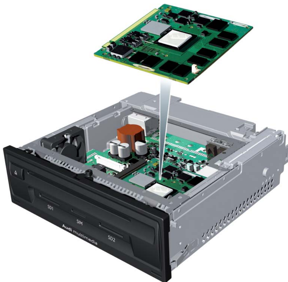
Représentation schématique de la carte MMX 618_002
