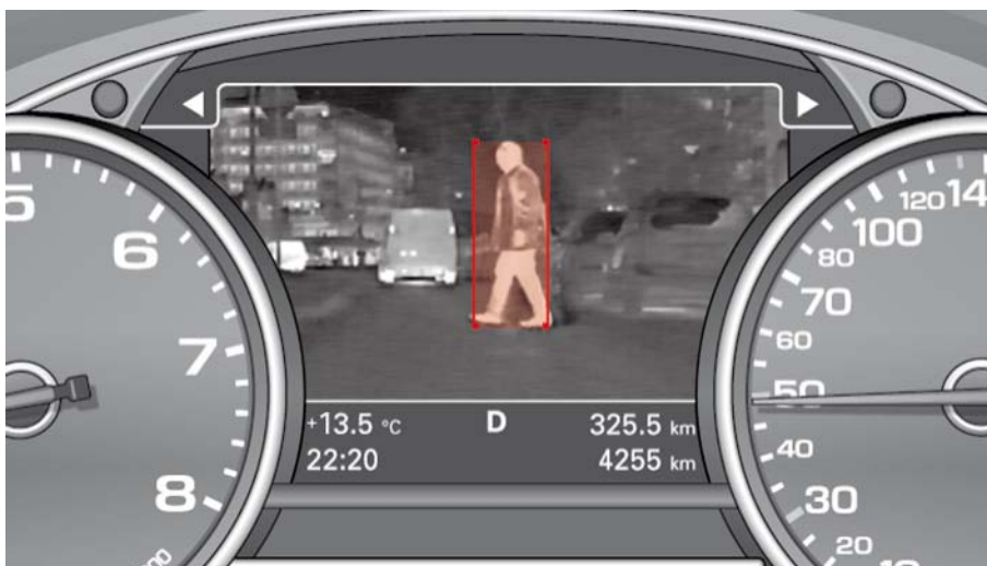
Repérage d'un piéton détecté sur l'écran du combiné d'instruments
