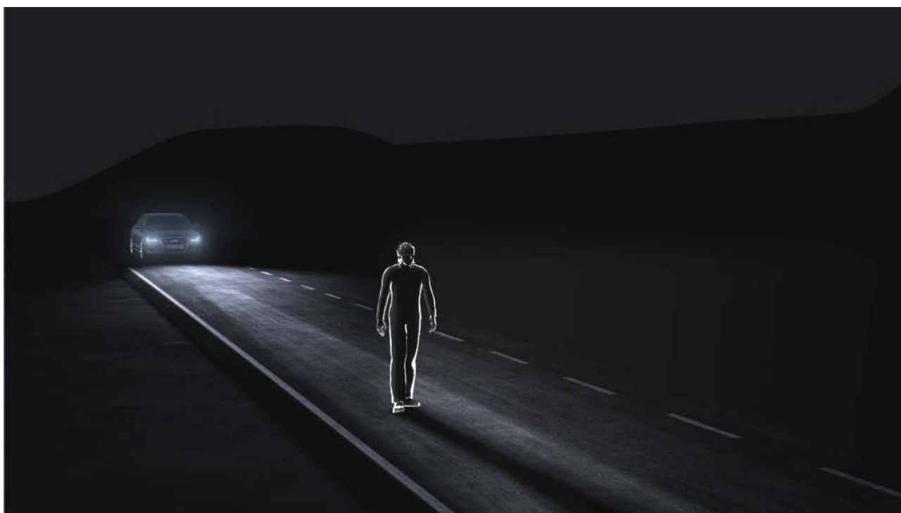
Repérage d'un piéton détecté par le projecteur Audi Matrix LED
