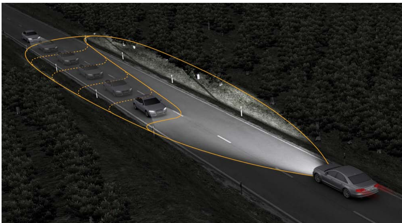
Principe de fonctionnement de la régulation progressive de la portée d'éclairage
