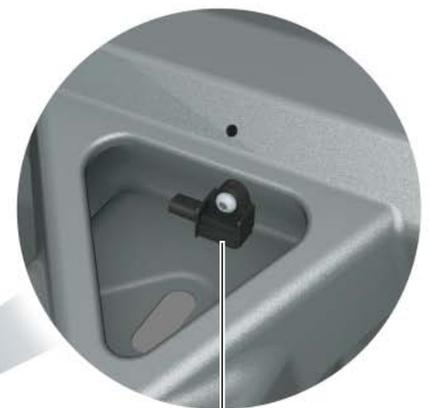
Capteur de collision de l'airbag latéral arrière, côté conducteur G256
