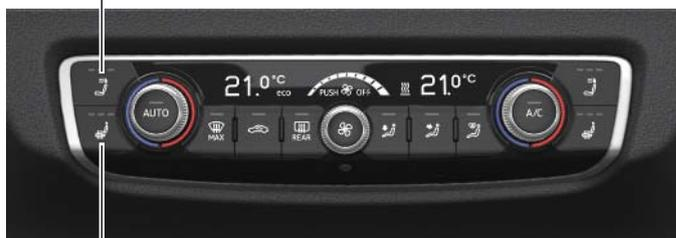
Touche de chauffage du siège côté conducteur
