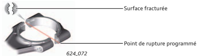
Cette désignation fait référence au mode de fabrication des bielles, où le corps de bielle est détaché du chapeau de bielle par une fracturation ciblée (cracking). L'avantage de ce procédé est que les deux morceaux fracturés s'ajustent exactement l'un à l'autre.
