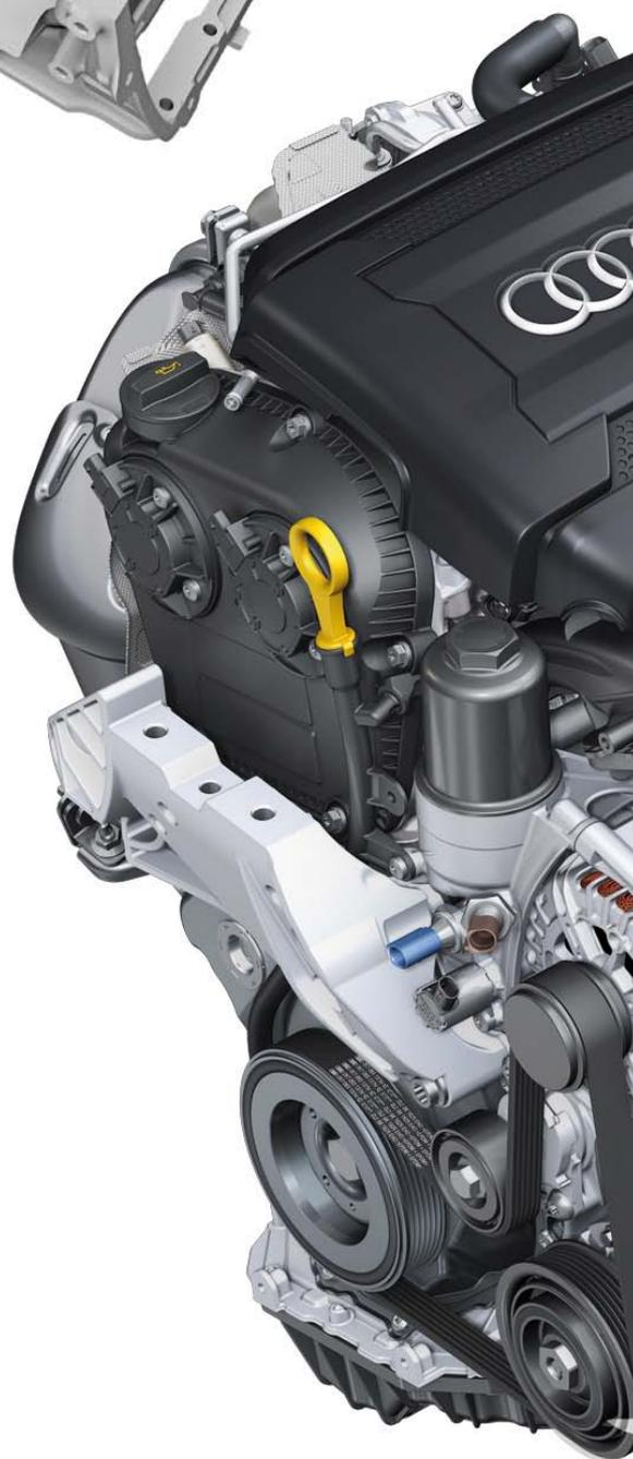
**Module de tubulure d'admission sans injecteurs MPI**
