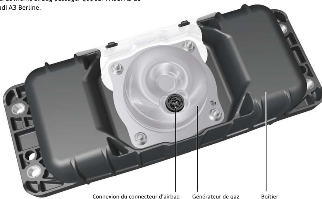
Connexion du connecteur d'airbag
