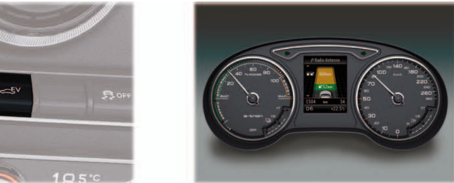
Combiné d'instruments avec puissancemètre et affichages « e-tron »
