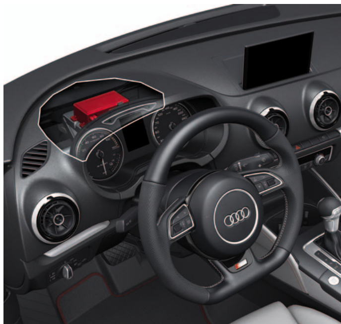
Emplacement de montage du calculateur J949
