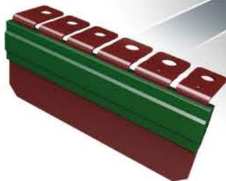
La protection par fusible multiple montée sur la face avant du boîtier électronique équipe également l'Audi TT. Il s'agit ici de plusieurs fusibles d'intensités différentes regroupés en une barrette de fusibles (d'où le terme de fusible multiple). L'alternateur, la direction électromécanique et le ventilateur de radiateur sont, par ex., protégés via cette barrette. En cas de défectuosité, seule la barrette de fusibles complète peut être remplacée.
