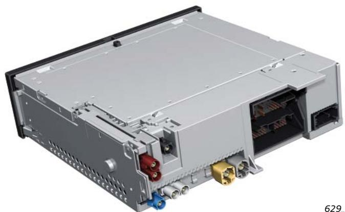
Face arrière du J794 avec MIB High et Audi connect
