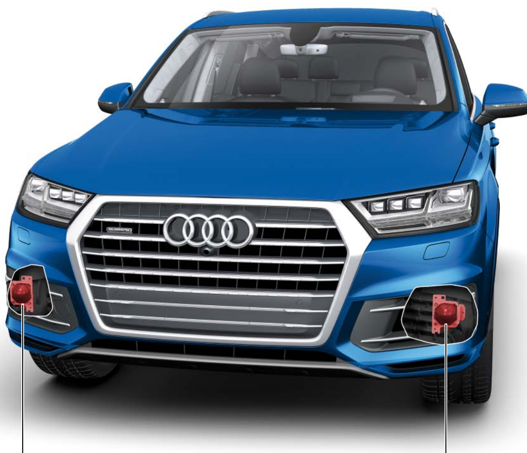
Transmetteur droit de régulateur de distance G259 et calculateur de régulateur de distance J428 (maître)
