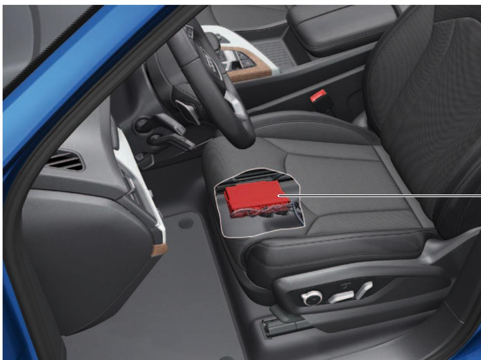
Calculateur de réglage du siège et de la colonne de direction à fonction mémoire J136
