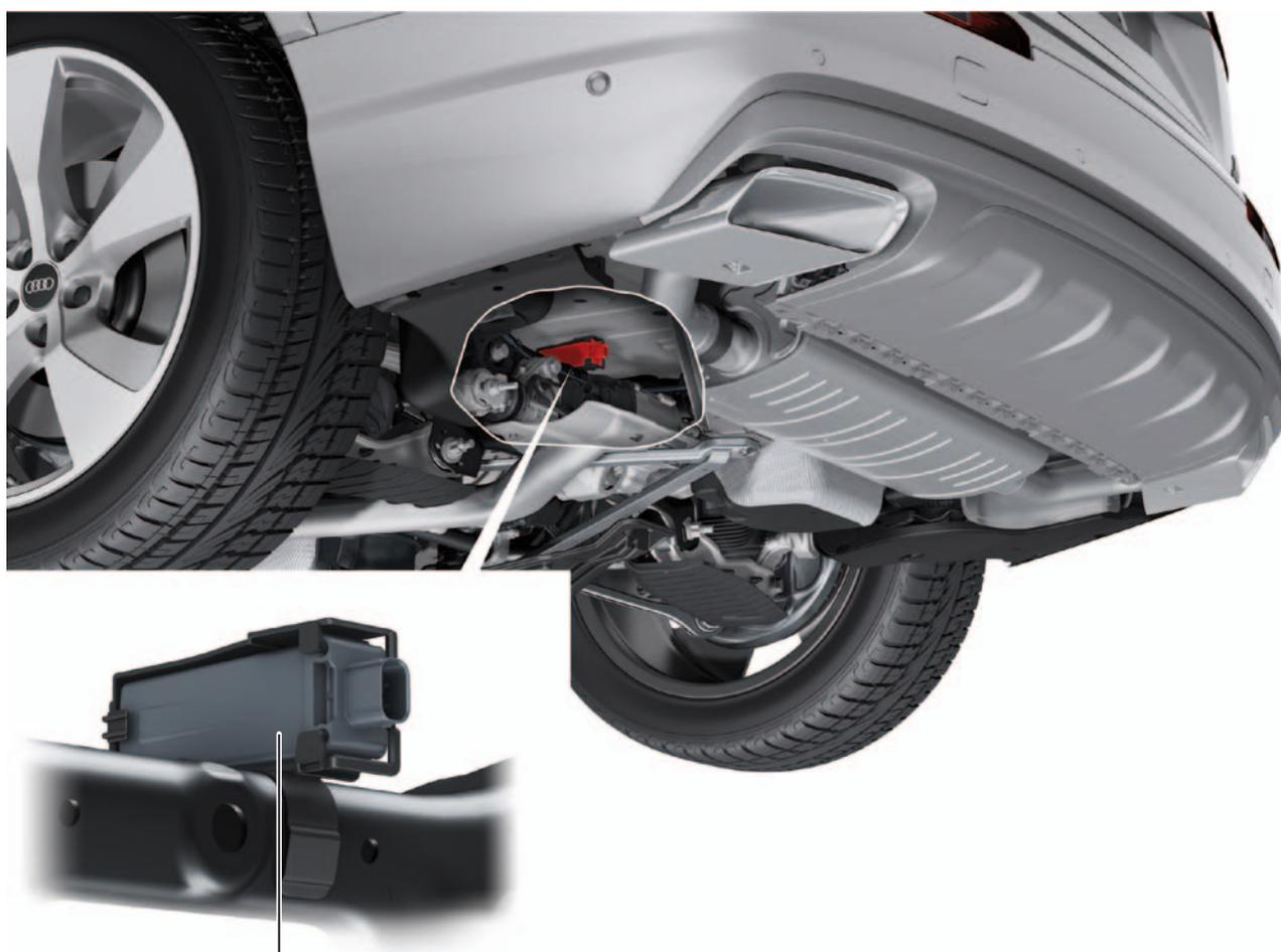
Calculateur de système de contrôle de la pression des pneus J502
