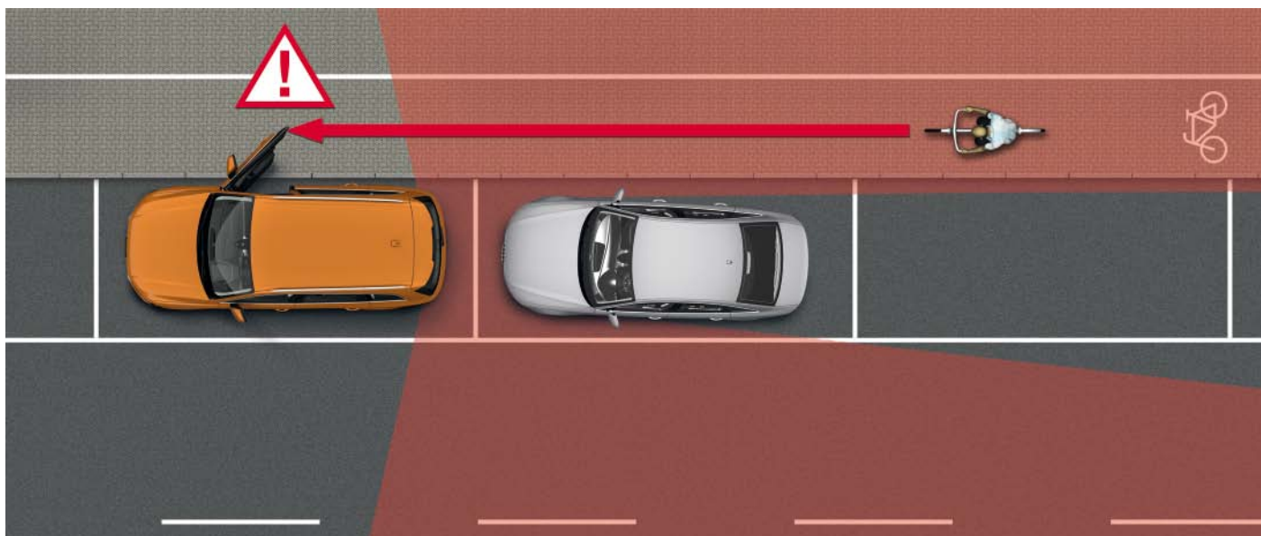
Risque de collision lors de l'ouverture de la porte du passager avant en cas d'approche d'un cycliste
