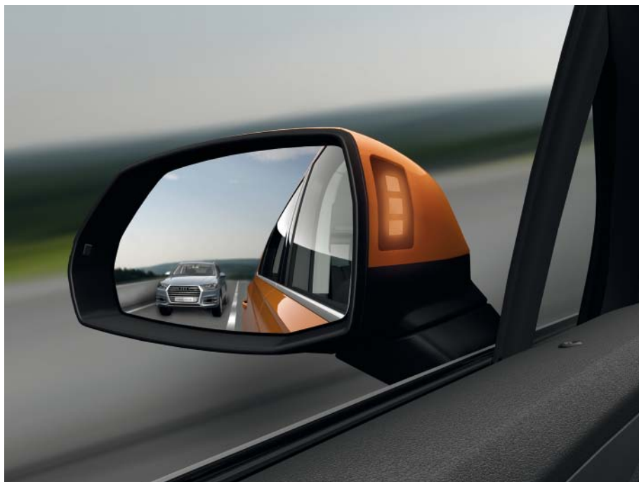
Témoin d'alerte actif de l'assistant de changement de voie dans le rétroviseur extérieur gauche
