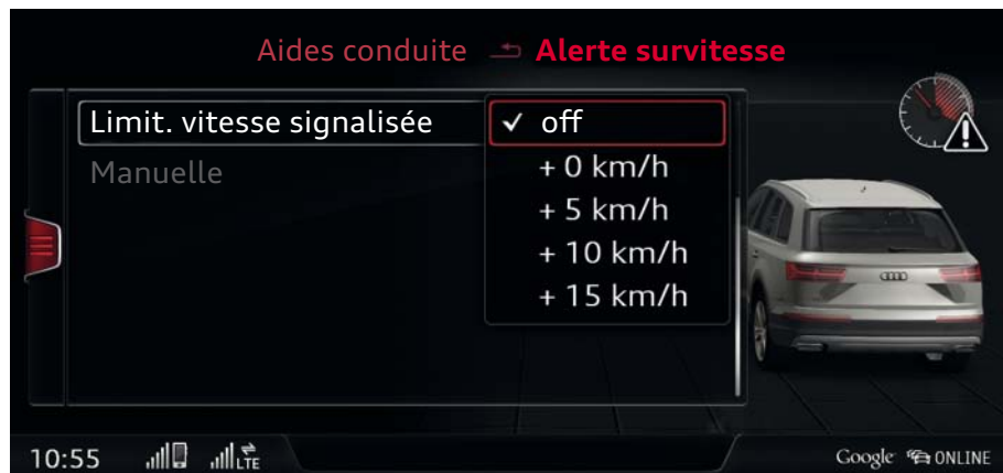
Réglage de l'offset de vitesse pour l'alerte de survitesse basée sur les panneaux de signalisation
