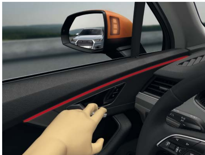
Alerte par le système d'avertissement de sortie lors de l'ouverture de la porte du conducteur
