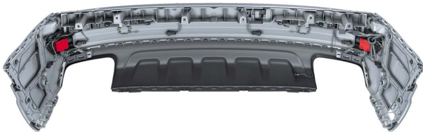
Emplacements de montage des deux capteurs radar sur le bouclier de pare-chocs
