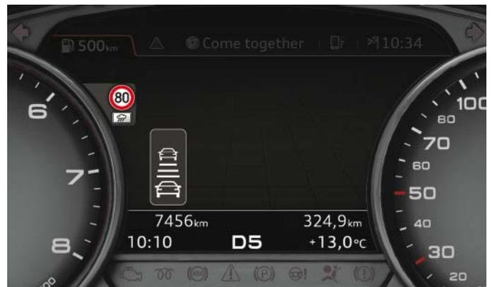
Détection des panneaux de signalisation et ACC
