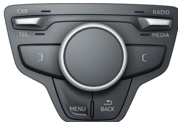
Unité de commande « Basic » avec boîte mécanique
