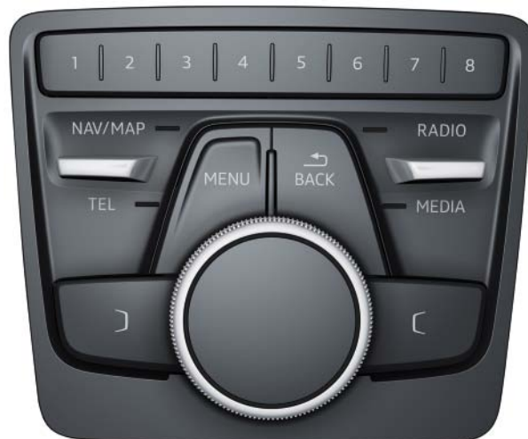
Unité de commande « Mid » avec boîte automatique
