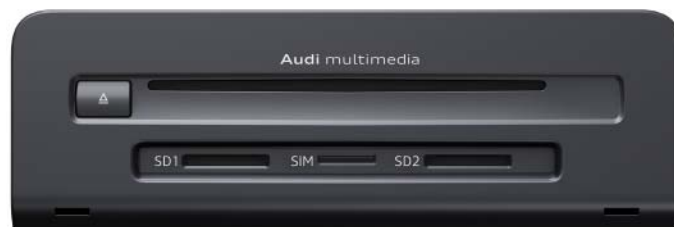
J794 avec MIB Scale avec module de données
