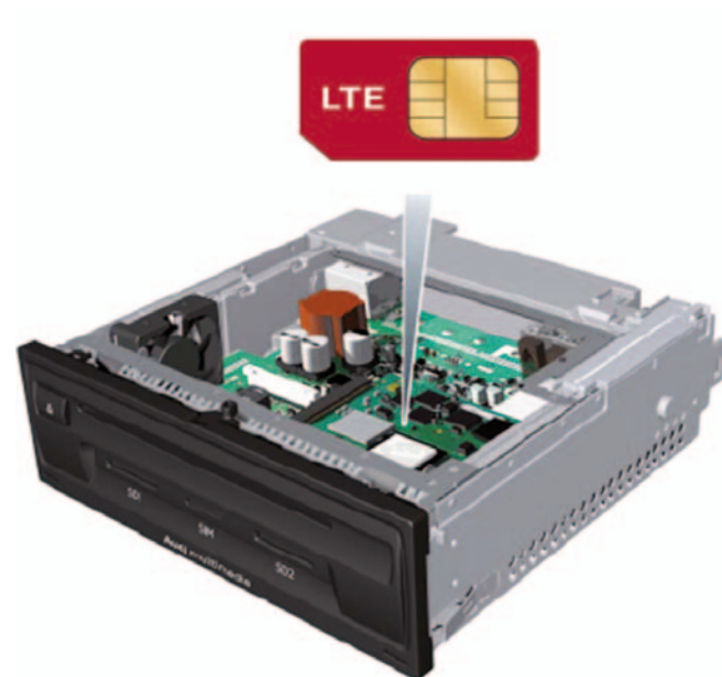
Calculateur d'électronique d'information 1 J794 avec carte SIM intégrée
