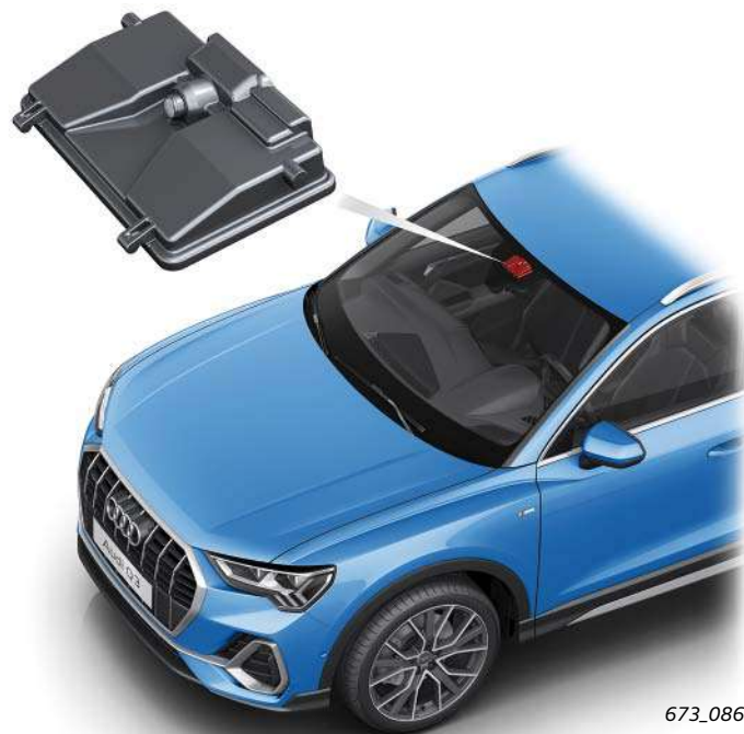
R242 Caméra frontale pour systèmes d'aide à la conduite
