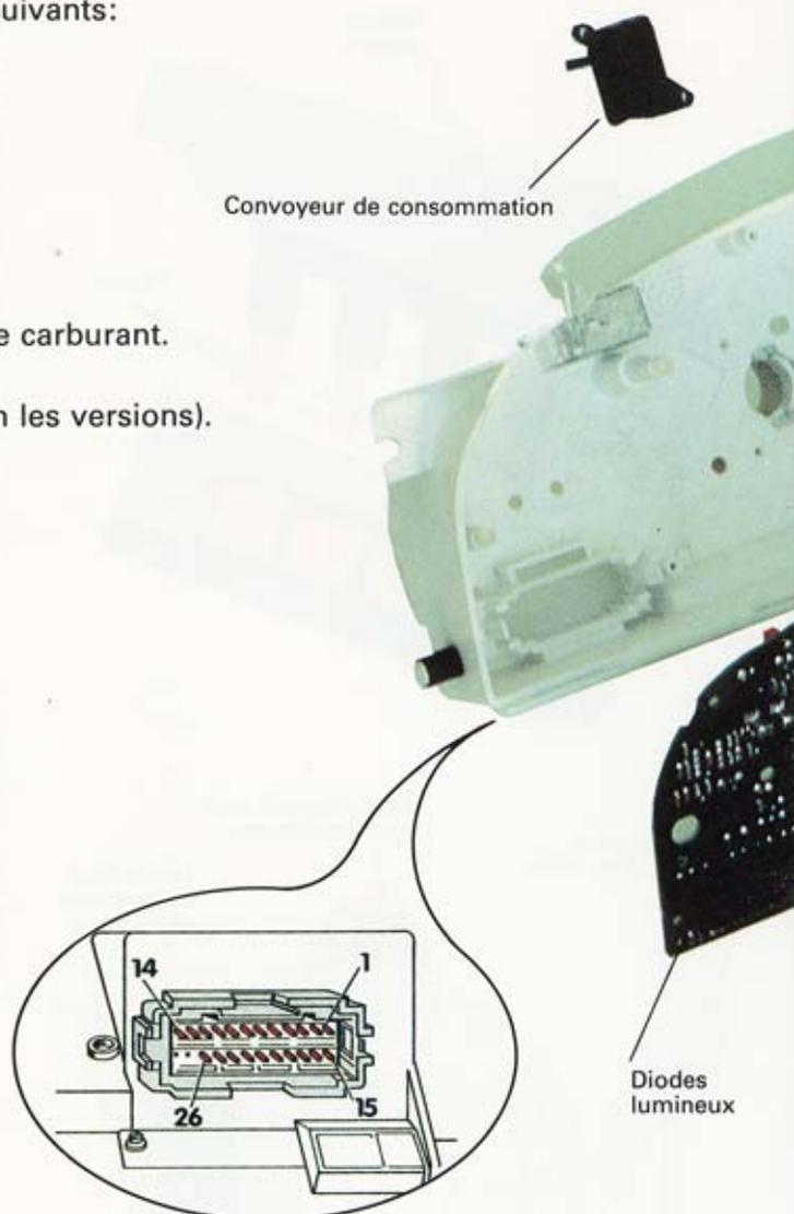
Les trois unités indicatrices ainsi que les diodes lumineuses des témoins de contrôle sont unies avec le circuit imprimé du tableau grâce à des pattes de connexion, ce qui fait qu'en cas de réparation les temps de substitution se voient réduits.
