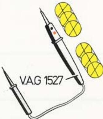
Un triple clignotement à intervalles indique l'existence d'une panne dans la zone du capteur de pression.
