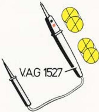
Un double clignotement de la lampe de diodes à intervalles indique l'existence d'une panne dans la zone du capteur de cognement.
