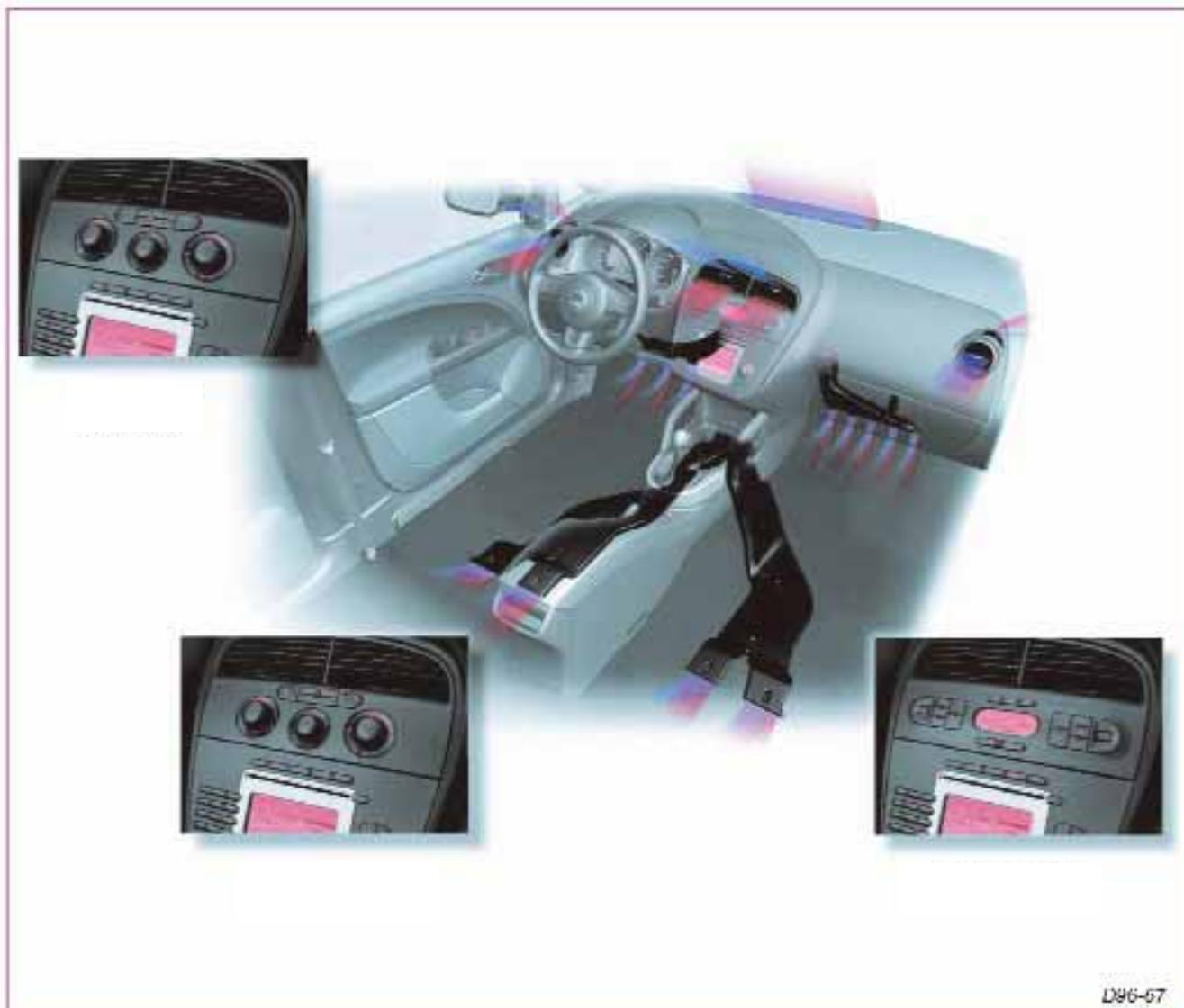
La SEAT Altea peut être équipée de trois versions d'appareil de climatisation.
