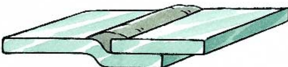
Soudure par chevauchement avec cordon plein. Elle s'effectue avec un équipement de soudage à l'arc.
