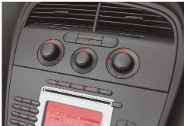
**Air conditionné semi-automatique :** Permet une climatisation optimale avec un minimum de composants, en combinant une régulation électronique et une régulation manuelle.
