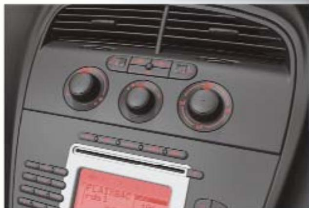
**Climatronic 2C** : il s'agit de l'option la plus performante, dont l'innovation principale réside dans le fait qu'il s'agit d'une climatisation bi-zone. Cela signifie qu'il est possible d'obtenir des températures différentes dans l'habitacle, une pour la zone droite et une pour la zone gauche. La régulation s'effectue de manière automatique.
