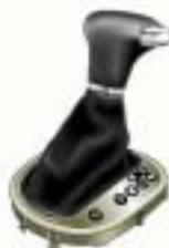
Le levier sélecteur actionne le tiroir mécanique de la boîte et transmet par l'électronique les sollicitations du conducteur en mode manuel ou Tiptronic.
