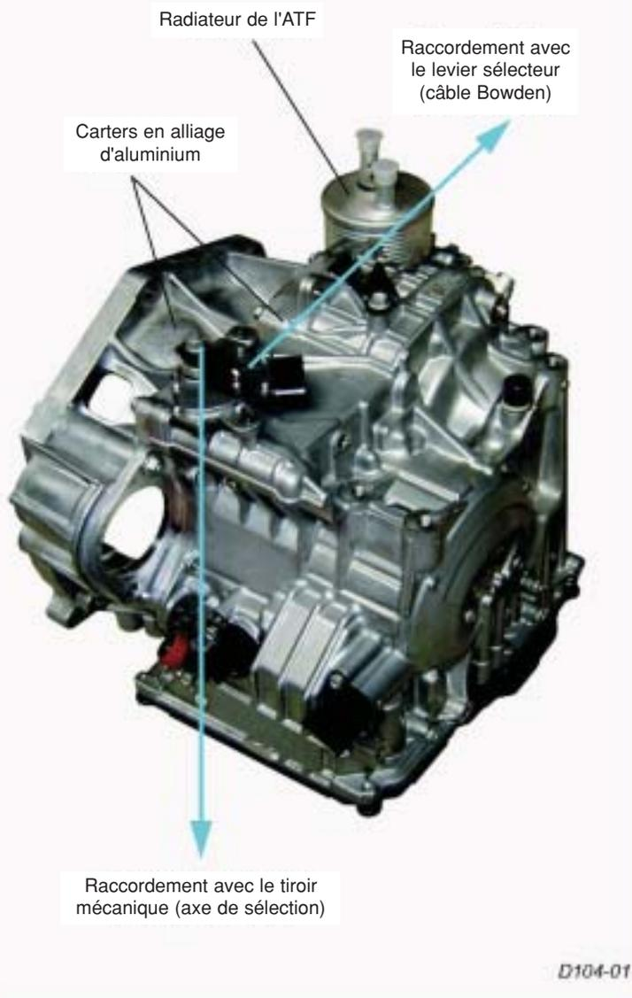
La commande hydraulique du système est assurée par huit électrovannes pilotées par l'unité de contrôle de boîte et, selon la position du tiroir mécanique, actionnées par le conducteur au moyen du levier sélecteur.
