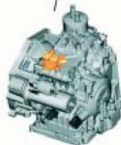
Les différents rapports de boîte transmettant le couple moteur aux roues sont obtenus à l'intérieur de la boîte automatique, par la combinaison mécanique (freins, embrayages, planétaires), hydraulique (convertisseur, vannes) et électrique (capteurs et actionneurs).
