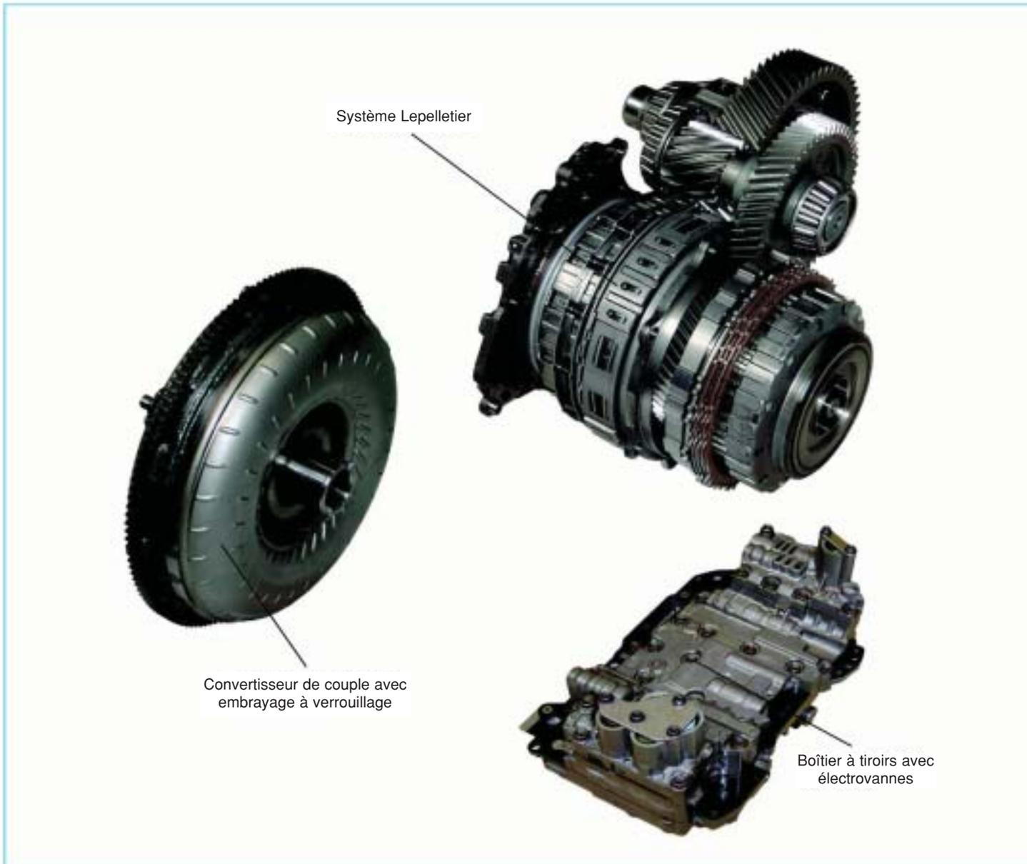
Sur le plan mécanique, la boîte 09G repose sur un **système Lepelletier** qui comprend un **engrenage planétaire simple et un autre double** (ensemble Ravigneaux).
