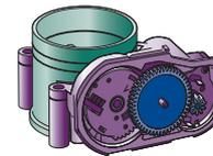
**Capteur de position de l'accélérateur électronique G79 - G185**
