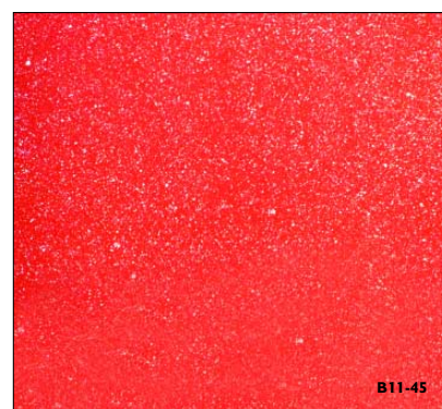
Les pulvérisations sur des pièces proches atteignent des pièces qui n'avaient pas besoin de peinture, mais qui ont reçu un masquage défectueux.
