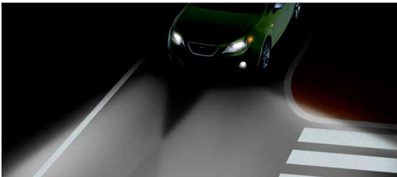
VÉHICULE DOTÉ DE LA FONCTION D'ÉCLAIRAGE ADAPTATIF « CORNERING »
