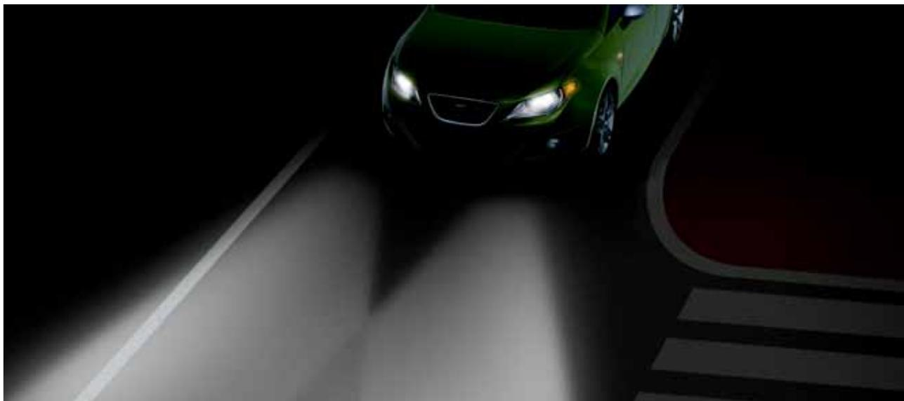
VÉHICULE NON DOTÉ DE LA FONCTION D'ÉCLAIRAGE ADAPTATIF « CORNERING »
